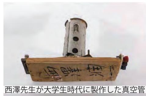
西澤先生が大学生時代に製作した真空管
