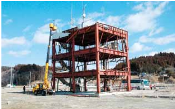
高所作業車を使った宮城県南三陸町防災対策庁舎の3次元レーザー測量状況
