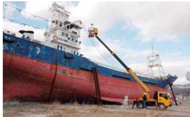
高所作業車を使った宮城県気仙沼市鹿折地区に打ち上げられた第十八共徳丸の3次元レーザー測量状況
