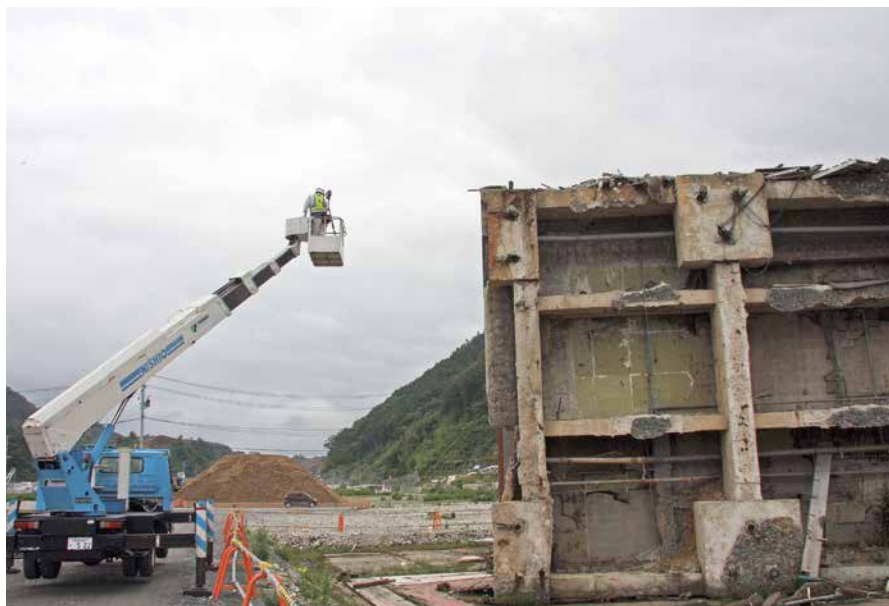
女川町の江島共済会館ビルの三次元計測（レーザースキャン）
