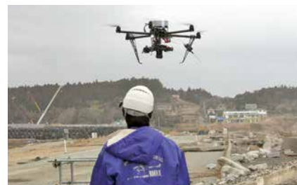
富岡町でのドローンによる三次元測量
