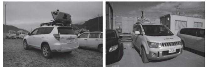
図 2. 計測に使用した車載レーザースキャナシステム (MMS)
