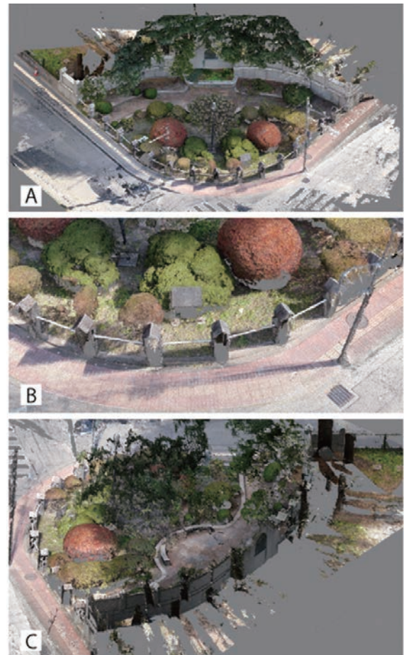
図 20 空中撮影だけで三次元化した小川記念園 (A: 俯瞰図、B: 歩道側門柱、C: 壁面裏)
