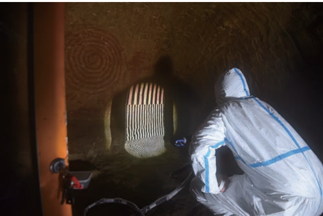
計測作業状況・複数のパターンを照射して計測を行う
