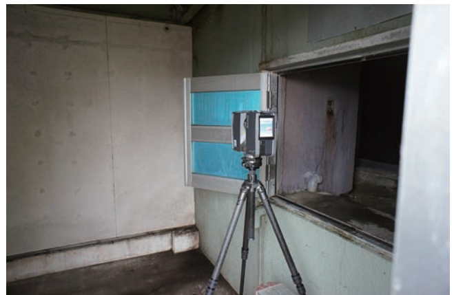
外側は地上レーザー計測・FARO 社製 Focus3D を使用
