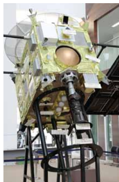
再突入カプセルが見える側。下面には各種機器があり、サンプラーホーンが突き出している
