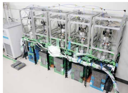
図2: 土壌測定にもちいた研究室の5台のゲルマニウム検出器 (最近われわれが開発した液体窒素を使わない新方式のもの)
