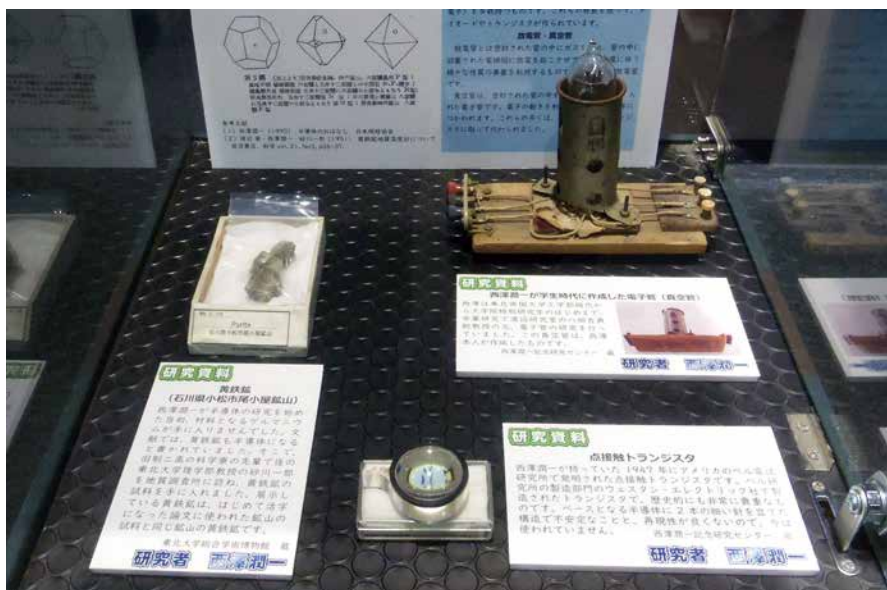
西澤が製作した電子管と点接触型トランジスタ(マイクロシステム融合研究センター蔵)、および実験に使用した黄鉄鉱と同じ産地の黄鉄鉱(総合学術博物館蔵)
