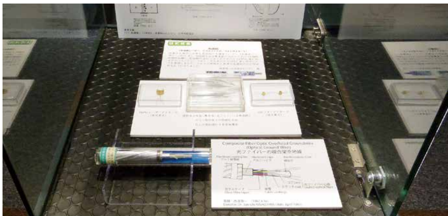
光通信3要素の半導体レーザー、ガラスファイバ、アバランシュ・フォトダイオードおよび製品化された光ファイバ
