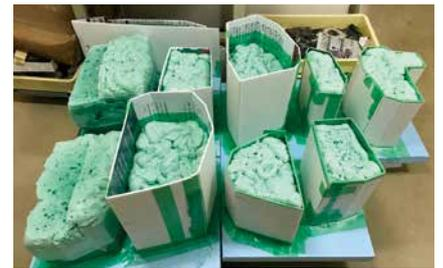
4. 各パーツをひっくり返してウレタンフォームを吹き付けたところ。いちばん左は底面を水平に切断する工程に入っている
